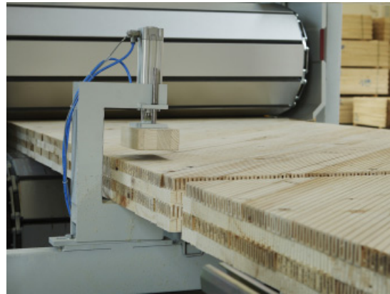
45° gedreht, kreuzweise verleimt
