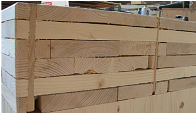
Appenzeller Brettsper Holz gedübelt
