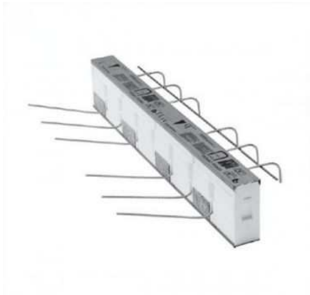
Fot. 4.2. Łącznik ISOPRO firmy Jordahl & Pfeifer, typ PI-IPQ do płyt podpartych przegubowo - przenosi tylko siły tnące [19]
