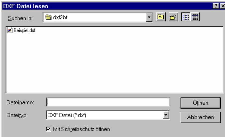
Die Auswahl der DXF-Datei erfolgt durch Markierung des Filenamens und anschließendem Drücken der Taste „Öffnen“ oder – schneller – durch Doppelklick auf die gewünschte Datei. Das Programm DXF2BT reagiert mit der Anzeige der eingelesenen Polylinien in grauer Farbe. Im Falle des mitgelieferten Beispielfiles BEISPIEL.DXF erscheint folgendes Bild:
